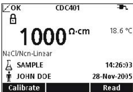
图 19 以电阻单位显示的电导率测量的例子
