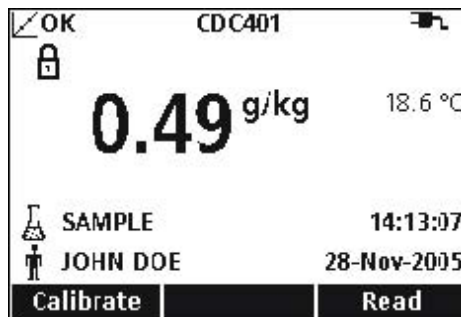
图 17 以盐度单位显示的电导率测量的例子
